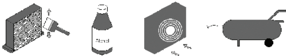
Figure 6 Nettoyage du condenseur
