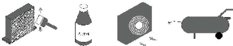
Figura 6 Pulizia del Condensatore
