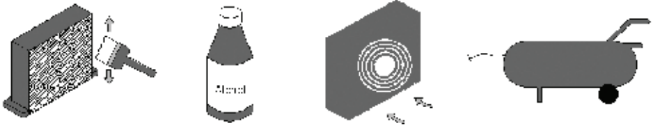
Bild 6 Reinigung des Kondensators
